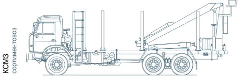
Сортиментовоз КСМЗ с гидроманипулятором предназначен для перевозки и самопогрузки сортиментов в составе одиночного автомобиля или автопоезда. Гидроманипулятор устанавливается на задней части грузовой платформы автомобиля.
