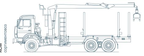
Сортиментовоз КСМ с гидроманипулятором предназначен для перевозки и самопогрузки сортиментов в составе одиночного автомобиля. Гидроманипулятор устанавливается за кабиной автомобиля.
