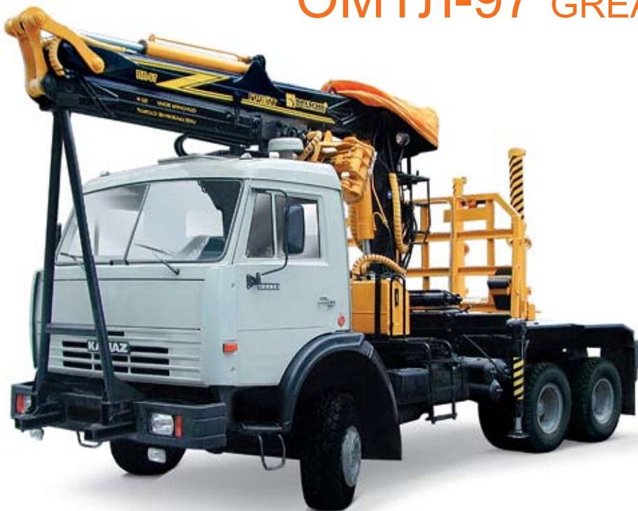
Манипулятор ОМТЛ-97 разработан для работы с «крупным» лесом, предназначен для погрузки сортиментов и хлыстов большой массы, имеет увеличенный по сравнению с манипуляторами серии ОМТЛ-70 грузовой момент, при сопоставимой массе.
