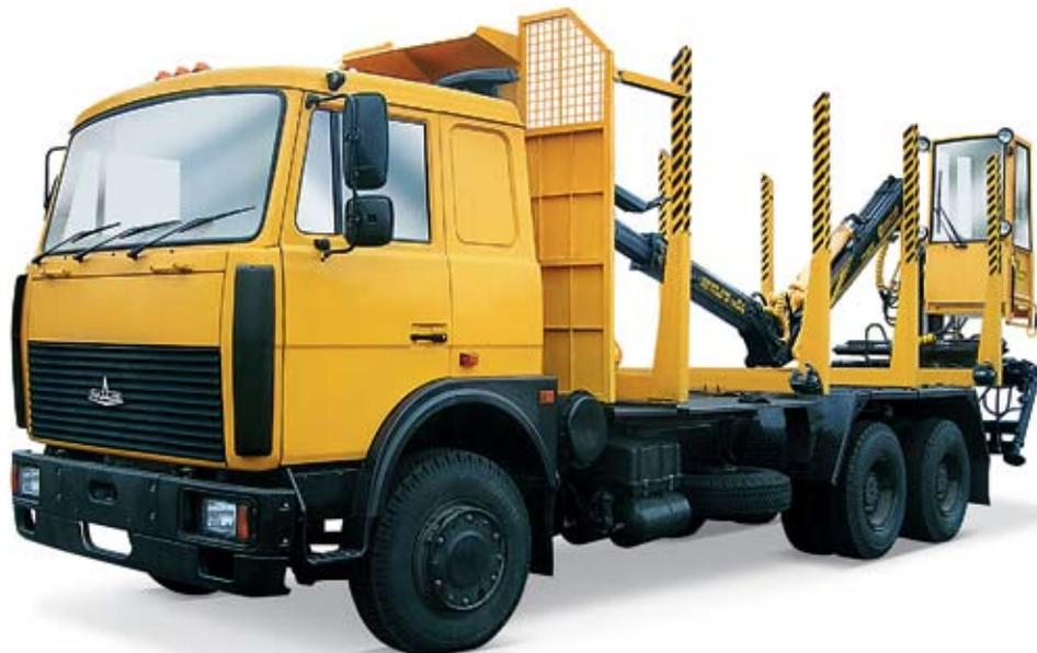
**ОМТЛ-97-04К – манипулятор с кабиной (модификация ОМТЛ-97). Наряду с высокой грузоподъемностью, данная модель оборудована двойным телескопическим удлинителем.**
