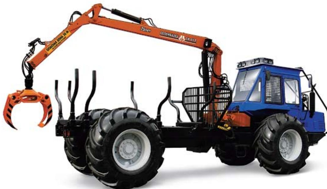
**Гидроманипулятор СФ-65Л – тракторный вариант СФ-65С. Фланцевое крепление опорно-поворотного устройства манипулятора к раме трактора.**
