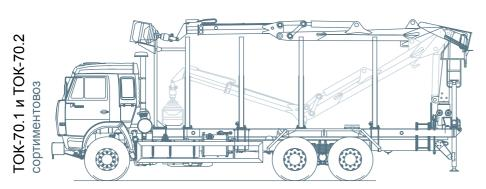
Автомобиль-сортиментовоз с технологическим оборудованием ТОК-70.1 и ТОК-70.2 предназначен для самопогрузки, транспортировки и саморазгрузки сортиментов на автомобиле и прицепе. Автомобиль и прицеп оборудованы грузовыми платформами с нераспашными кониками. На задней части грузовой платформы автомобиля устанавливается манипулятор, который обслуживает автомобиль и прицеп.
