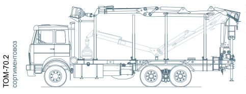
Автомобиль-сортиментовоз с технологическим оборудованием ТОМ-70.2 предназначен для самопогрузки, транспортировки и саморазгрузки сортиментов на автомобиле и прицепе. Автомобиль и прицеп оборудованы грузовыми платформами с нераспашными кониками. На задней части грузовой платформы автомобиля устанавливается манипулятор, который обслуживает автомобиль и прицеп.
