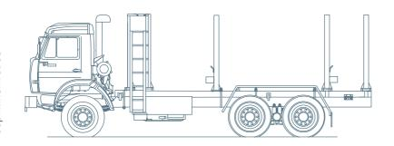
Сортиментовоз КС предназначен для перевозки сортиментов в составе одиночного автомобиля или автопоезда.
