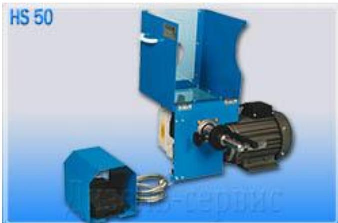
Окорочный станок предназначен для снятия поверхностного слоя резины со шланга в соответствии с технологией обжима 3-х, 4-х и 6-и оплеточных РВД. Станок способен производить наружную и внутреннюю окорку шланга с возможностью регулирования глубины окорки и длины окашиваемой поверхности
